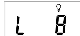
③ Wechseln Sie zur gewünschten Helligkeitsstufe 0 (dunkel) bis 9 (hell) durch Drücken der linken oder rechten Taste am Display (Bild 11)
