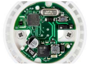
Abb. 5 Verschrauben Sie den Sockel an Wand oder Decke. Lochabstand 30 mm. Verwenden Sie Befestigungsmaterial, das für den Untergrund geeignet ist. Siehe auch Informationen zur Hohlwandmontage.
