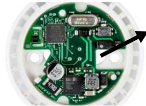
Abb. 4 Entfernen Sie die KNX-Klemme. Führen Sie das Buskabel durch die Kabel-Durchführung im Sockel und schließen Sie es an der Klemme an.
