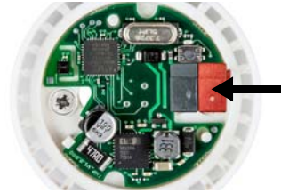
Abb. 6 Stecken Sie die KNX-Klemme mit dem Buskabel auf den Steckplatz.
