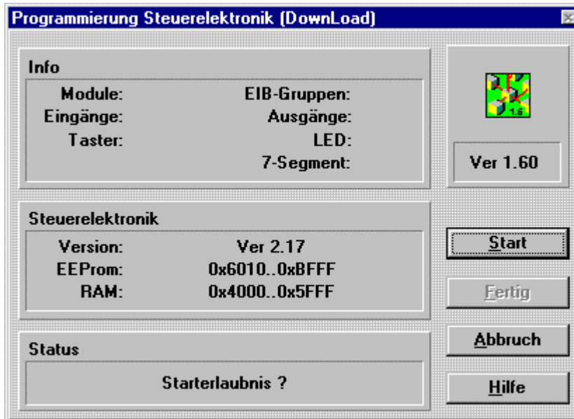
Abbildung 24: Dialogfenster „Programmierung“ vor der Übertragung
