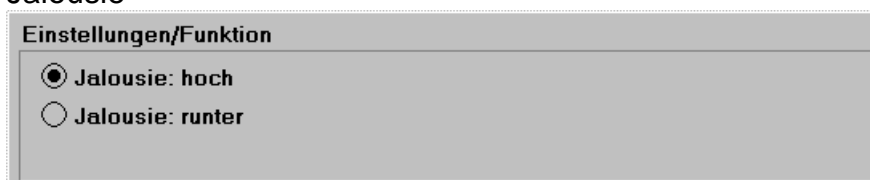
Abbildung 17: Einstellungen für Eingang/Taster mit Jalousiefunktion
